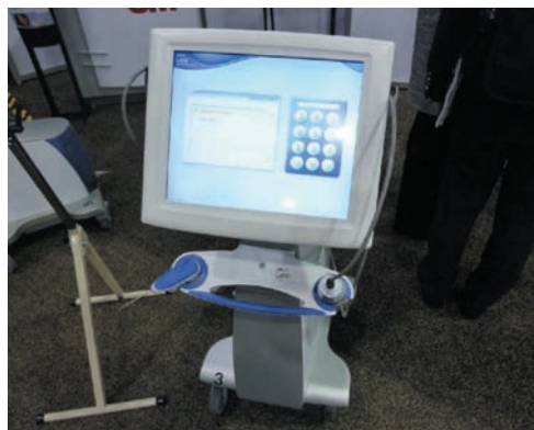
図1 日本で最初に導入される口腔内スキャナーLAVA COS (3M)。17インチのモニターはタッチスクリーン式で、2D/3Dの表示切り替えができる。
